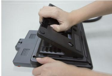
Monte el teléfono en la parte posterior de la base. Asegúrese de que el seguro en la base y el orificio en el teléfono encajan. Sujete la base y tire suavemente hacia abajo.
