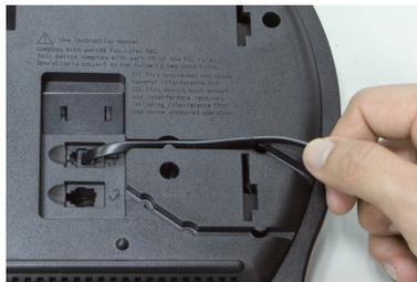
Conecte el cable del auricular en la parte posterior de la base. Ponga el cable en la ranura.
