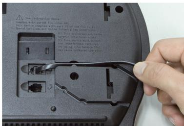
Inserire il cavo della cornetta nella parte posteriore del telefono. Inserire il cavo nell'alloggiamento predisposto.
