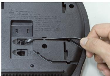
Stecken Sie das Handset Kabel in die Rückseite der Basisstation. Legen Sie das Kabel in den Kabelkanal.
