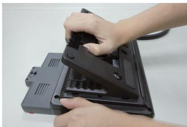
Montez le socle à l'arrière sous le Media Phone, en vous Assurant que le socle est correctement positionné. Pour bien fixer le socle, enfoncez-le légèrement.
