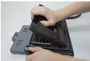
Montare il supporto nella parte posteriore del telefono, assicurarsi che il laccio sul sup-porto ed il foro sul telefono combacino. Maneggiare con cautela.
