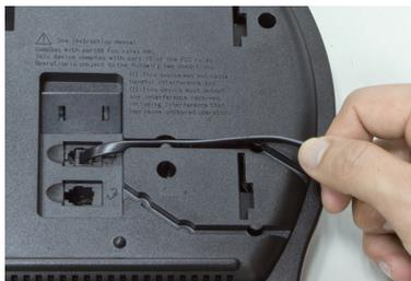
Plugar o cabo do aparelho atrás da estação base. Coloque o cabo no entalhe do cabo.
