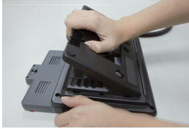
Bei der Montage des Gestells an die Media Telefon Rückseite, stellen Sie sicher, dass der Riegel auf dem Gestell und das Loch auf dem Media Telefon verknüpft sind. Halten Sie das Gestell und ziehen Sie es vorsichtig nach unten.
